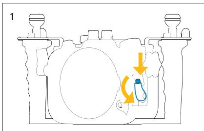
ポートリリースレバーのセーフティボタンを下側に押し、レバーを手前に倒します。付属のボディキャップを外します。
