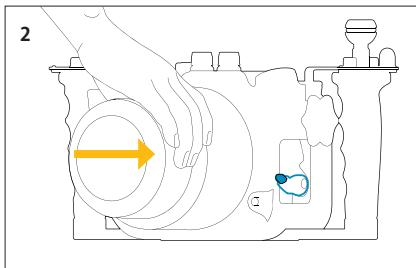
ポートからOリングを取り外し、傷や付着物がないか確認します。付属のOリンググリスを薄く伸ばした後、ポートの溝に収めます。ポートとハウジングの取り付け指標を合わせ、ポートを奥まで押し入れます。
