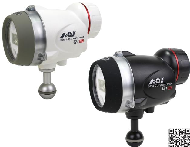
●ガイドナンバー:22 ●色温度:5000K ●照射φレンズ(換算24mmレンズ)の画角をカバー(陸上値) ●リサイクルタイム:0.85秒(FULL発光) ●発光回数:1500回(FULL発光) ●接続方法:光ファイバーケーブル ●ライト機能:700ルーメン・光量調整3段階・照射角45° ●サイズ:W77×H131×D125mm ●重量:550g(陸上)、90g(水中)
