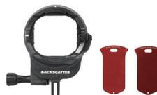
ワイコン (UWL-03) と水中映像の補正フィルターを、同時にセットできるマウントベース。着脱はスライド式でワンタッチのフィルターはDIVE (水深5~20m) と、深いDEEP (水深20m以深) の2タイプ。
