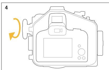
ハウジングのズームノブを回し、レンズのズーム作動が正しく行われるか確認し、ハウジングのリアケースを閉じてください。
