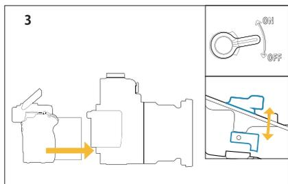
カメラを装填する前に、ハウジングのON/OFFレバーを持ち上げておきます。
