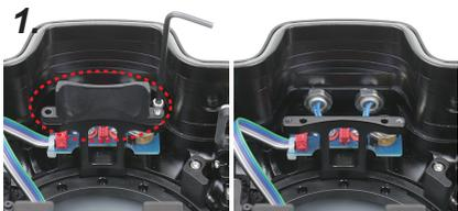
上部のプレートを、図のように六角レンチで外しておきます。バッテリー交換後は、元に戻します。
