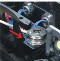
1. 爪楊枝などで後ろ側から下の電池を押し出します
