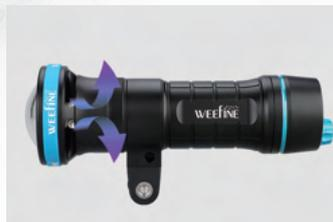
ライトヘッド部は水が対流することで、大光量の発光による過熱を防ぐデザインになっています。大光量による長時間発光にともなう発熱を効率よく冷却し、安定したライティングを継続することができます。
